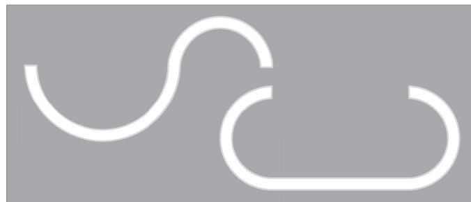
Przykład łączenia w linię świetlną: 1200mm i 800mm In-line installation: 1200mm and 800mm
